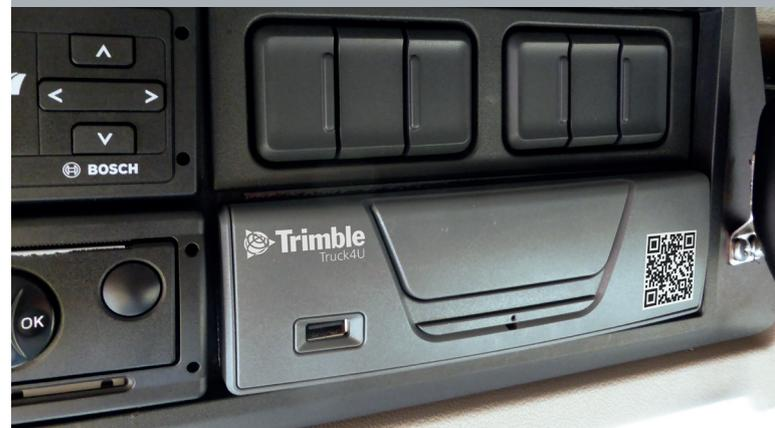
Truck4U est un ordinateur intégré dans le tableau de bord au format DIN. Il est livré avec sa propre carte Sim pour gérer les communications de données fiables et illimitées dans toute l'Europe.
